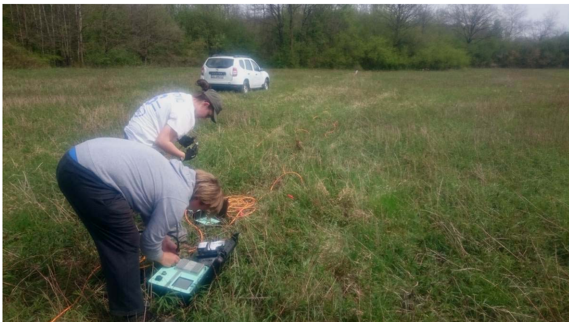
Slika 4.3-3: Postavljanje elektroda za snimanje profila tla metodom geoelektrične tomografije
