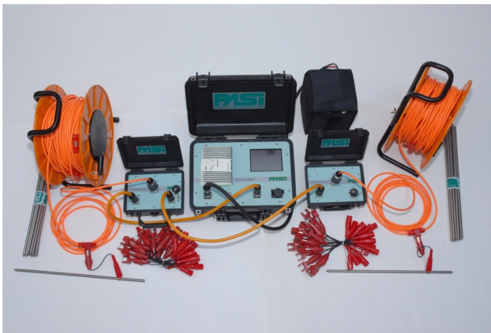
Slika 7.5 Oprema za geoelektrična mjerenja.
