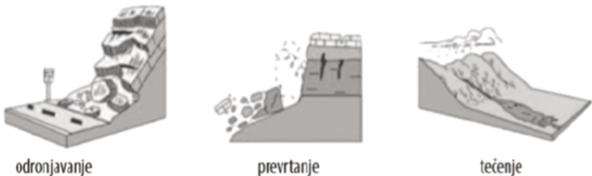
Slika 14: Prikaz osnovnih tipova klizanja prema mehanizmu kretanja
